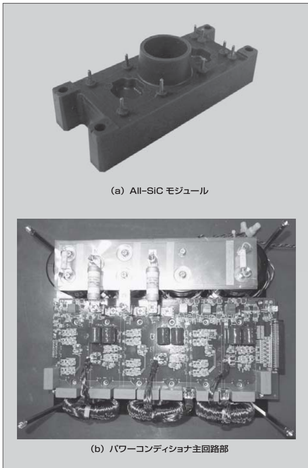
図9 太陽光発電用パワーコンディショナへの適用
