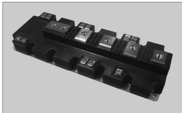
図1 3 レベル電力変換器用大容量 IGBT モジュール
