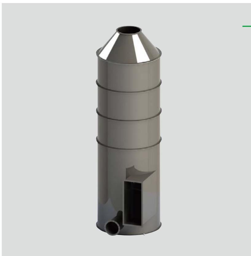
船舶からの大気汚染を防止するため、国際条約 (MARPOL 条約) に基づき、排ガス規制が順次強化されている。富士電機は、2015 年から強化される SO<sub>x</sub>・PM 規制に対応した船舶用排ガス浄化システム (サイクロン式 SO<sub>x</sub> スクラバ) を開発した。本装置は、排ガス中に海水を噴霧し、その液滴に SO<sub>x</sub> を溶解させて低減する。主な特徴を次に示す。
