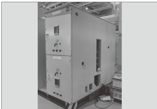
図5 耐震検証用高圧配電盤
