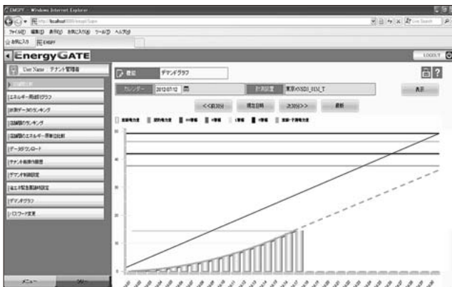
図4 デマンド監視機能の画面例
