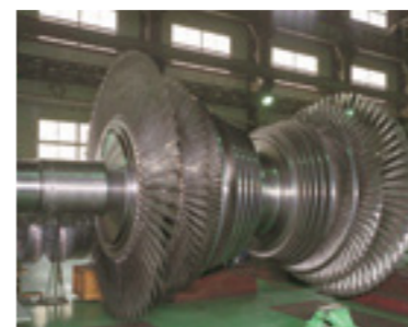
地熱発電用タービン
