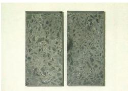
ガラス化した放射性廃液を閉じ込めたセメント固化体
