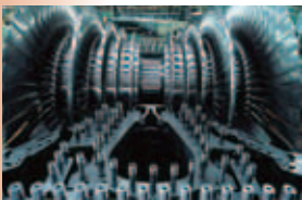
蒸気タービン
