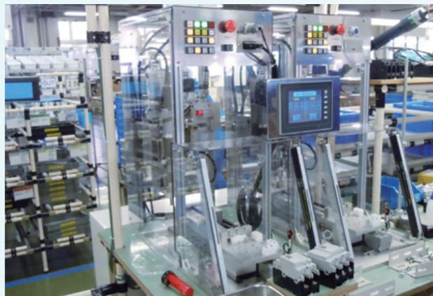
ネジ締め簡易自動化装置
