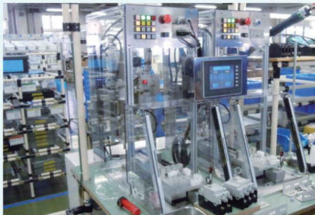
ネジ締め簡易自動化装置
