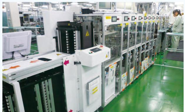
自動化したプリント基板の検査ライン
