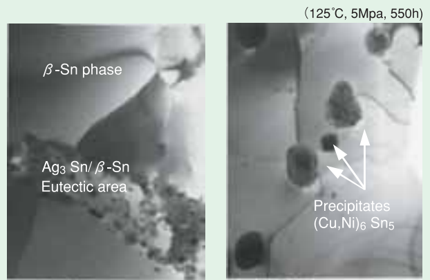
破断前 破断後 クリープ破断前後の組織(透過電子顕微鏡による)
