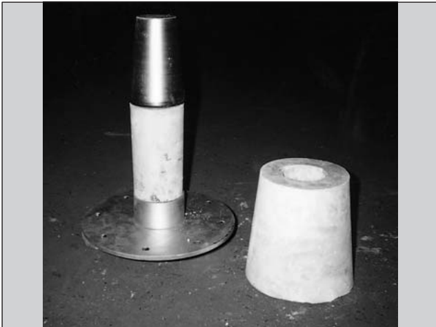
図7 ガスバブリング装置の外観
