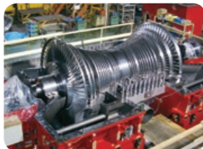
蒸気タービン
