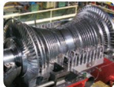
蒸気タービン
