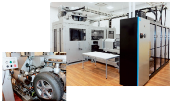
WLTPに対応したタイヤ試験装置
