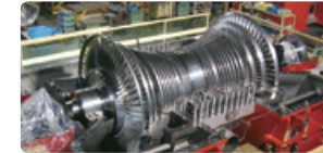
蒸気タービン
