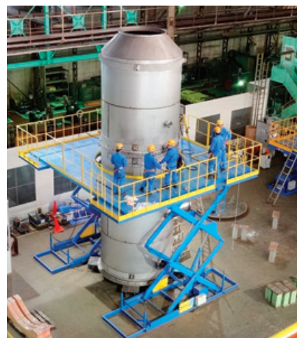
当社製SOxスクラバは98%以上の高い脱硫率で、世界全海域に適用可能
