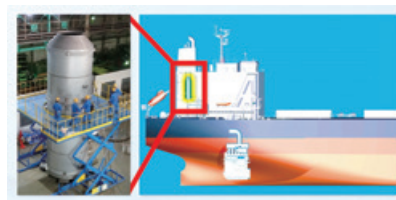
船舶用排ガス浄化装置
