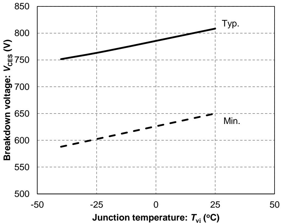
一般的に半導体素子は、低温になるに従ってシリコン結晶内の格子振動が低下しキャリアの衝突が抑制されます。これによりインパクトイオン化率が高くなるため、素子耐圧が低くなります。したがって低温での使用が想定される状況に置きましては、その耐圧低下を含めた設計をお願いいたします。
