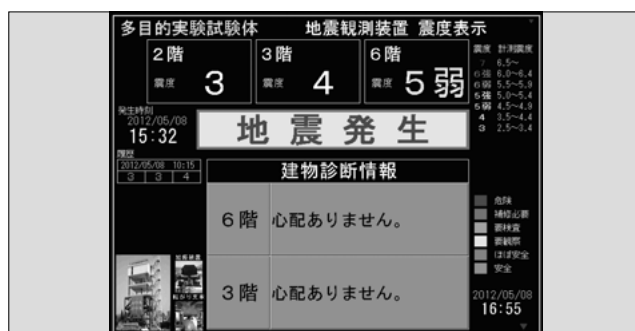
震度・建物健全性診断モニタの表示例
