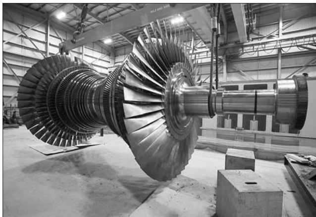
図 10 据付け中の地熱タービンロータ
