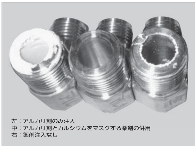
図7 アルカリ注入法によるシリカスケールの抑制結果
