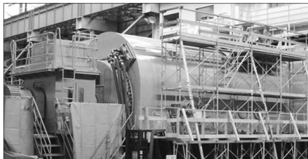
図11 工場試験中の全含浸絶縁水素間接冷却タービン発電機
