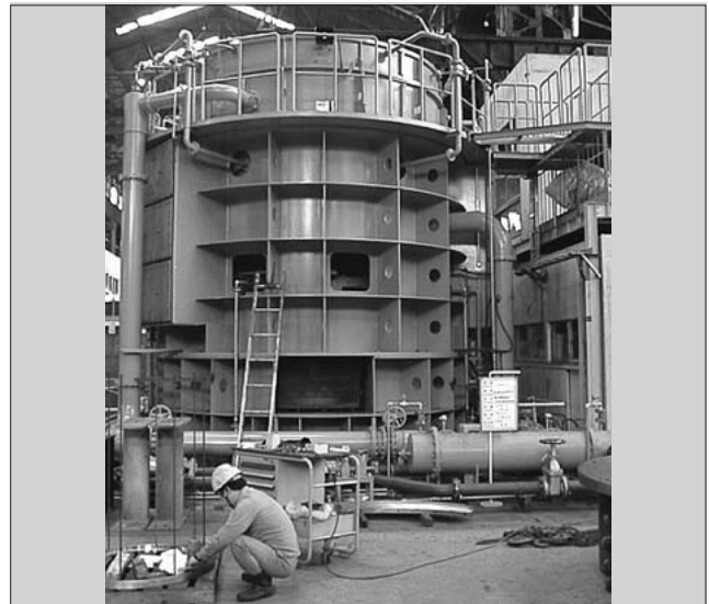
図8 70 m/s 級自己循環ポンプ実験装置
