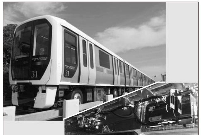
図9 ゆりかもめ7300系車両とドアシステム
