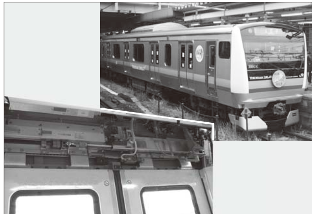
図11 埼京線・横浜線 E233系車両とリニア方式ドアシステム
