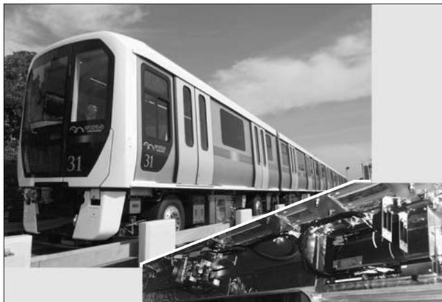
図7 ゆりかもめ車両とFCPM方式戸閉装置
