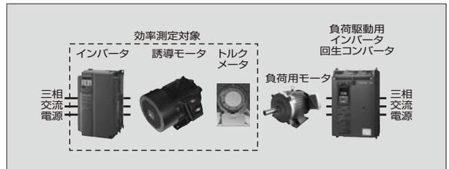
図7 効率検証試験の構成
