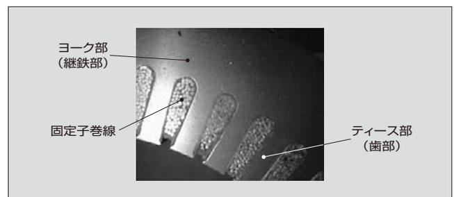
図 5 固定子鉄心の断面（部分）
