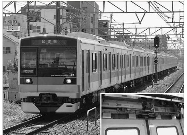
図5 JR 東日本 E233 系電車とリニアモータ方式戸閉装置
