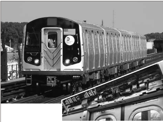
図3 NYCT-R160 電車とリニアモータ方式戸閉装置
