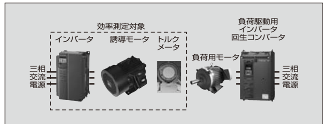
図7 効率検証試験の構成
