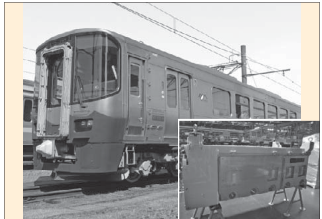
図7 ET122系気動車と電源装置
