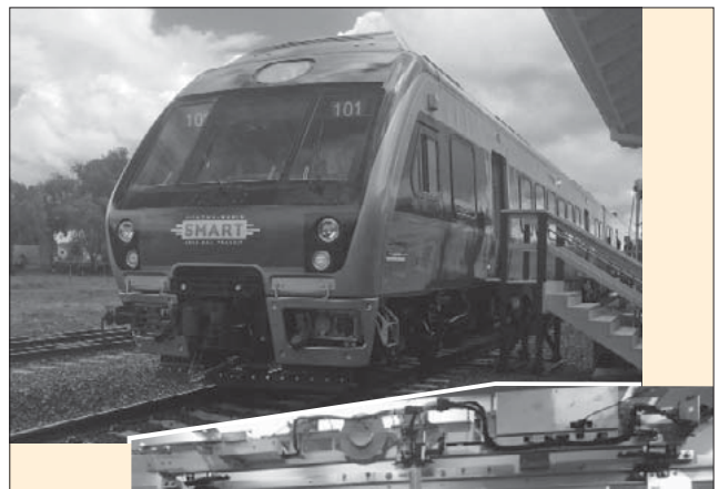
図8 新型車両とラック・アンド・ピニオン方式ドア駆動装置
