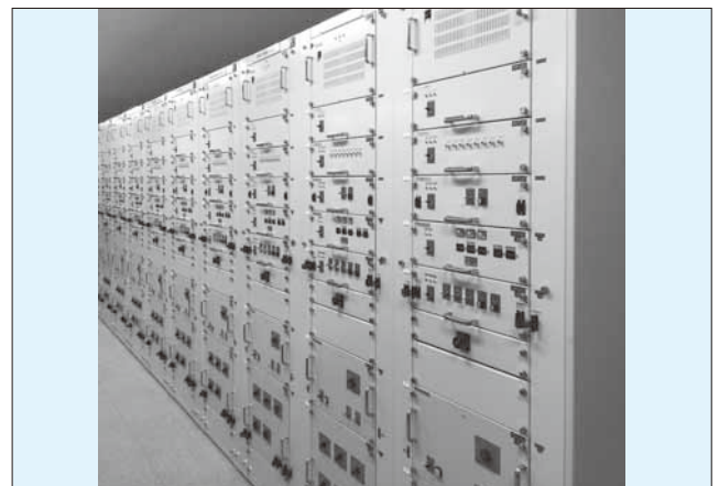
図2 電力系統解析シミュレータ (多機能発電機モデル)
