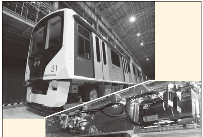
図6 330 形車両とラック・アンド・ピニオン方式ドア駆動装置
