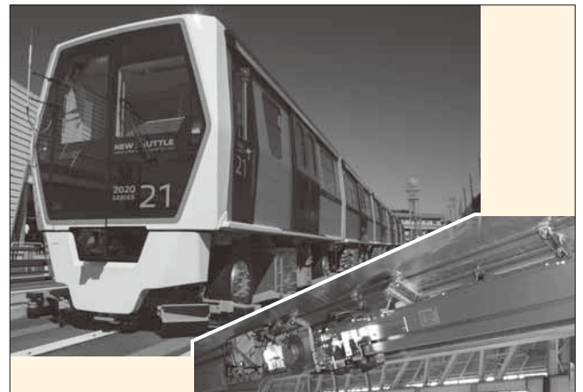
図7 2020系車両とラック・アンド・ピニオン方式ドア駆動装置
