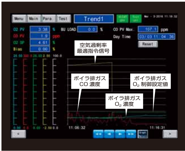
図8 ボイラ燃焼ソリューション緊急停止試験結果
