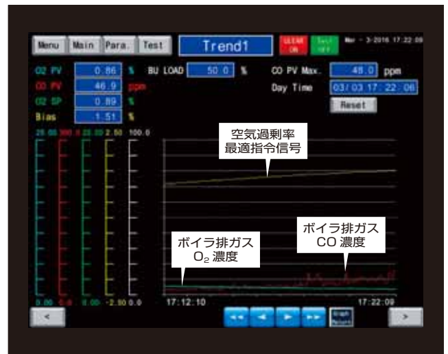
図7 超希薄空気燃焼自動制御試験結果
