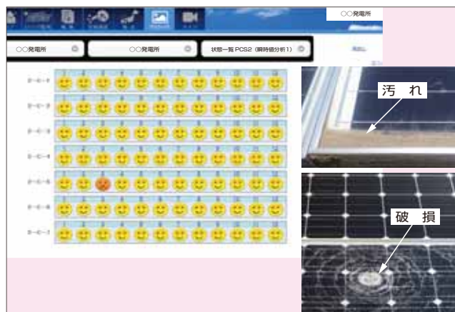
図3 計測システムの画面例と太陽光パネルの異常状態
