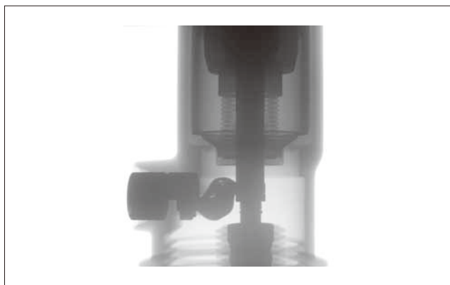
図8 極柱のX線透過写真
