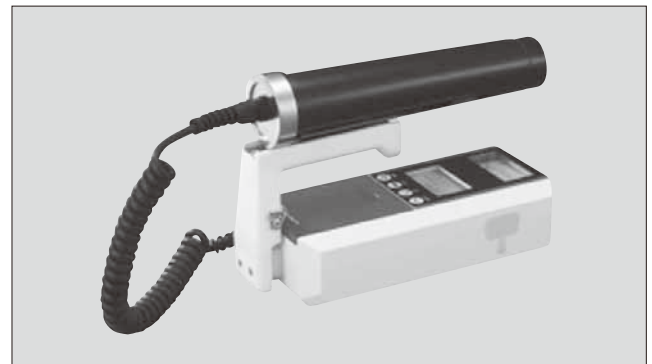
図3 スペクトルサーベイメータ「NHC8」
