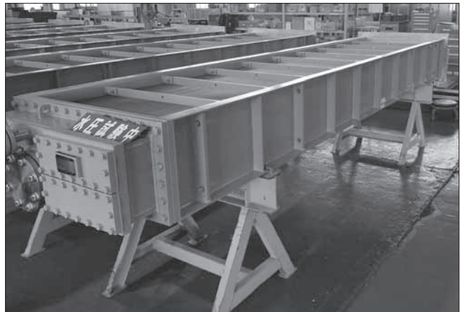
図5 空気冷却器の水圧試験時の様子
