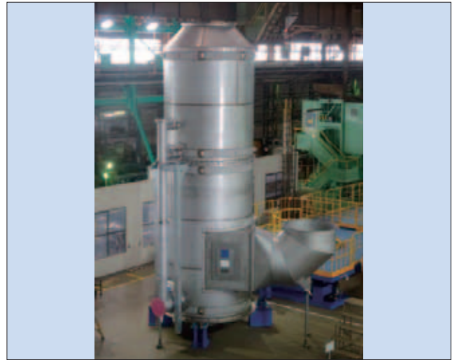
図8 船舶用排ガス浄化システム (サイクロン式 \text{SO}_x スクラバ)
