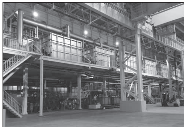
図7 連続熱処理・表面処理ライン
