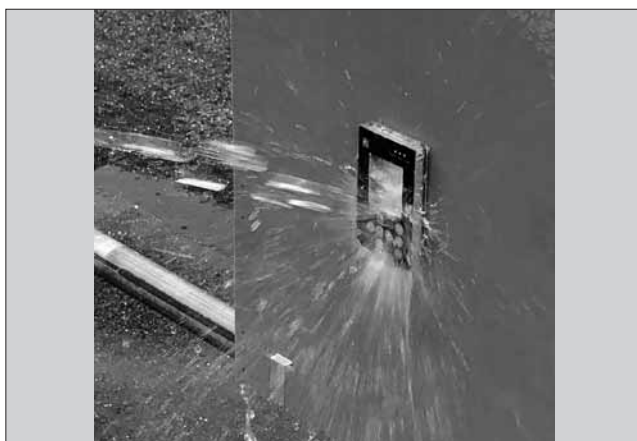
図9 新多機能キーパッド防水試験風景
