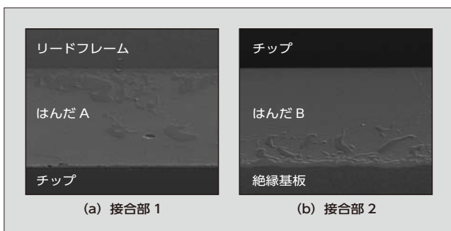
図9 連続通電試験後のはんだ接合部の断面
