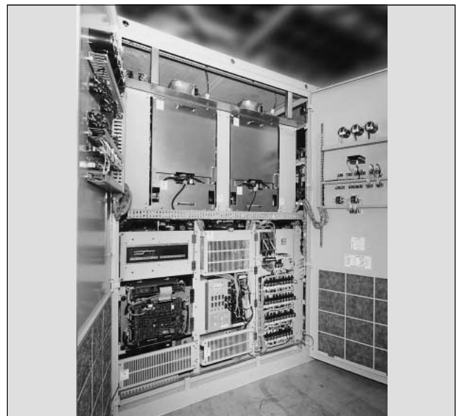
図3 IGBT インバータモジュールの実装状態
