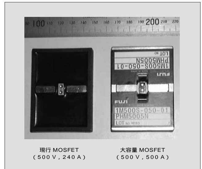
図 1 現行 MOSFET と大容量 MOSFET の外観
