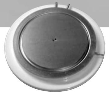
大容量シリコン整流素子 形式：ER3211FL-50 繰返し逆電圧：5,000V 平均順電流：3,200A サージ電流：58,000A
