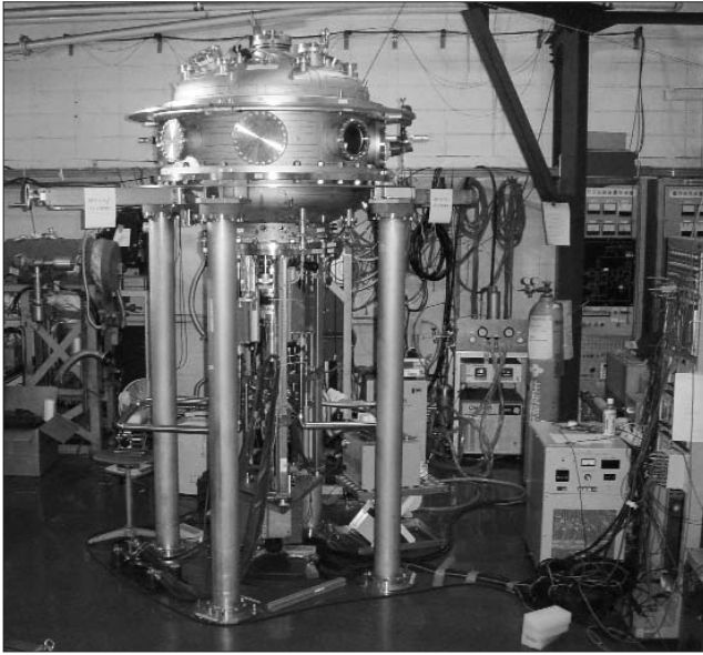
図4 Mini-RT の本体真空容器とその付属装置
