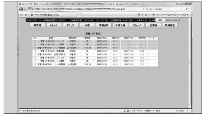
図 8 監視画面による多機能リレーの動作履歴管理
