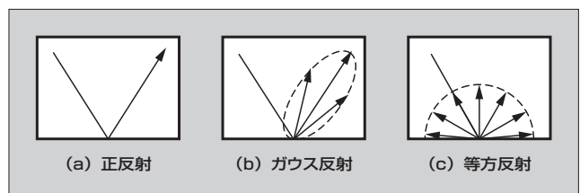
図6 導光板内の光の拡散性
