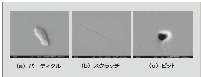
図 5 アルミ基板の代表的な微小欠陥
