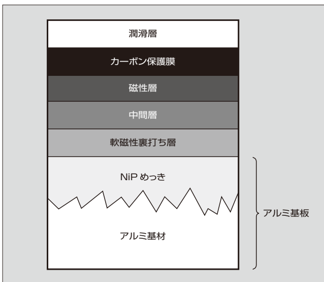
図1 磁気記録媒体の基本構成
