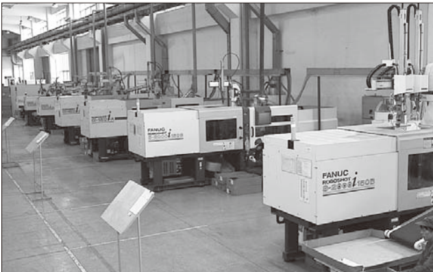
図6 内製化の例（電磁開閉器のモールド成型）
