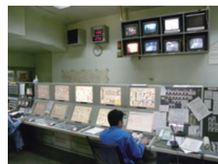
セメントの生産プロセスを見える化する生産監視制御システム
