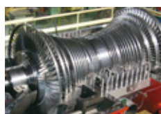
蒸気タービン
