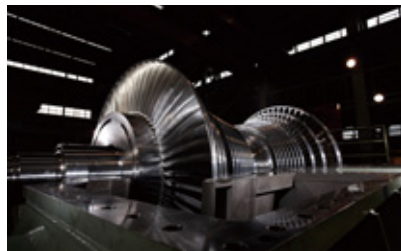
蒸気タービン
