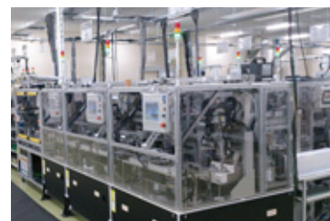
自動化したインバータの組立ライン(鈴鹿工場)
